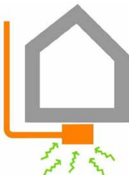
Figura 16: depressione del sottosuolo tramite pozzetto.
